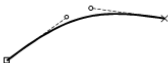
Fig. 13: Una curva di Bézier selezionata evidenzia il nodo iniziale, i vertici e le tangenti, ed il nodo finale
