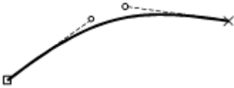
Fig. 13: 始点、頂点、切線および終点で現わされる選択された曲線
