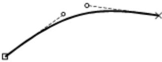
Obr. 13: Vybrané Bézierovy křivky zobrazující začínající bod, uzlový bod, tangenty a koncový bod
