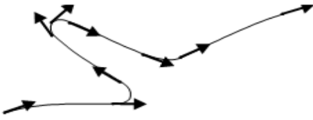
Fig. 2: Point d'inflexion d'une courbe de Bézier
