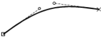
Fig. 13: 始点、頂点、接線および終点で現わされる選択された曲線
